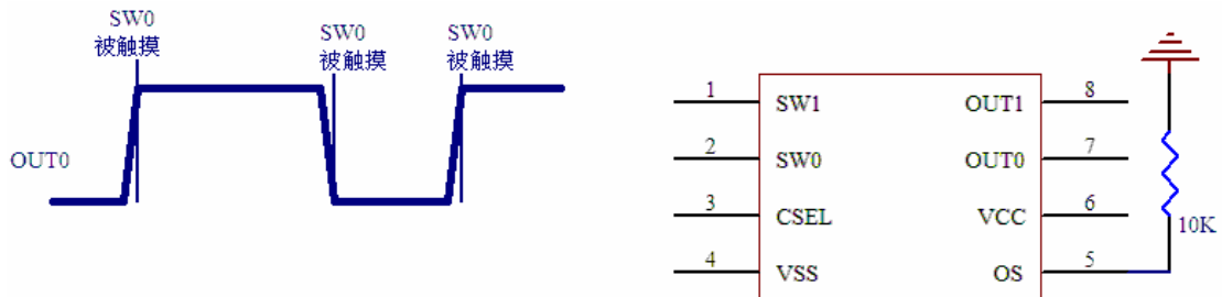
图 3: WTC02SP 引脚 OS 接 GND 时 SW0 按键输出时序图
